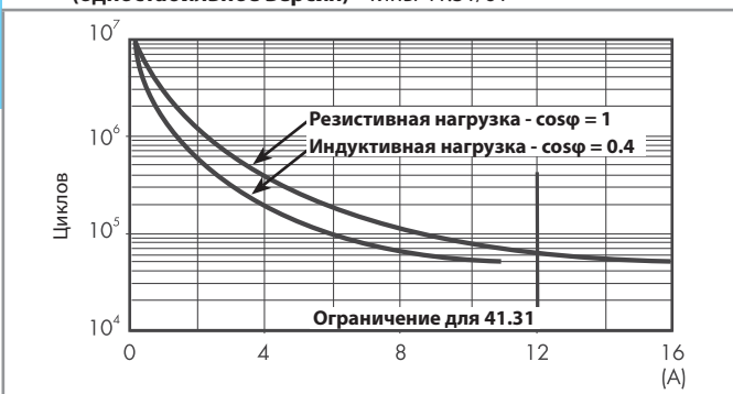
F 41 - Электрическая долговечность (АС) при различной нагрузке на контактах (бистабильные версии)
