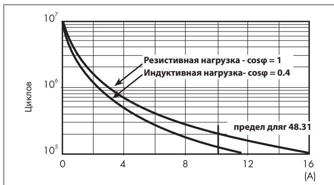
F 48 - Электрическая долговечность (AC) при ном. нагрузке, Типы 48.P5/52
