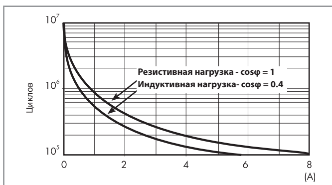
F 48 - Электрическая долговечность (AC) при ном. нагрузке, Типы 48.P5/52
