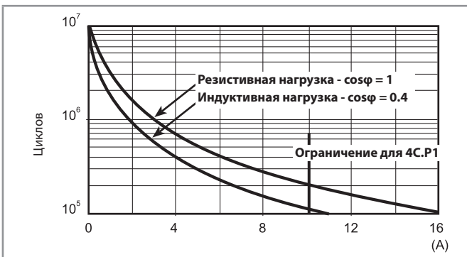
F 4C - Электрическая долговечность (AC) при ном. нагрузке, Типы 4C.01/P1
