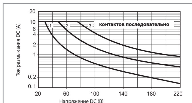
H 60 -Макс. отключающая способность DC1
